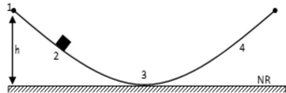
4. En la figura, desde el punto 1 se suelta el cubo de 10 kg, deslizándose por la superficie lisa hasta llegar al punto más bajo (4) con una energía cinética de 280 J, determina a) la altura en el punto 1, b) la rapidez en el punto 2.
